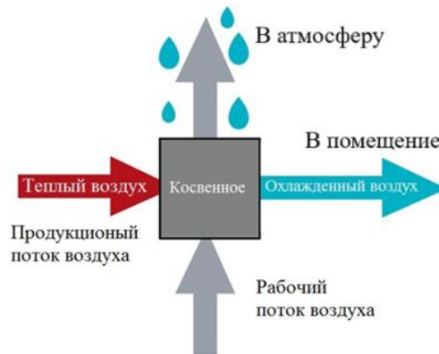
Рис.1. Схема движения потоков воздуха в аппарате КИО
