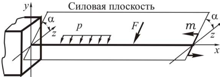
Рисунок 2.1 – Плоский косой изгиб
